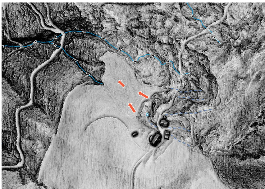
Slika 3: Pogled na ponovno aktiviran plaz pod objektom Onkraj Meže 8 – označeno z rdečimi puščicami. S polno modro črto so prikazani vidni tokovi vode, s črtkano črto pa so označene grape z občasno precejno vodo. Precejne vode v retijskih apnencih ponikajo preko razpok in se na kontaktu s filitoidi pojavljajo (na površju) kot posamezni izviri.
